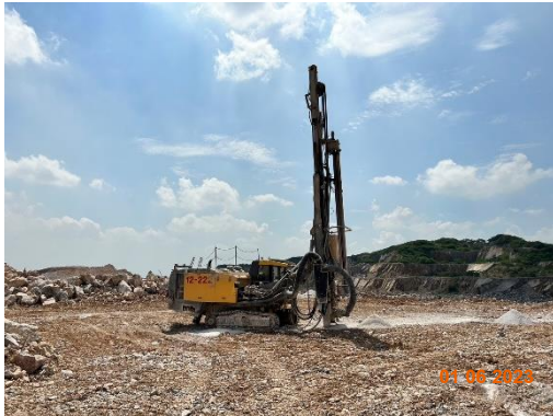
รูปที่ 2-7 เครื่องเจาะรูระเบิดที่มีระบบ Cyclone และถุงกรอง
