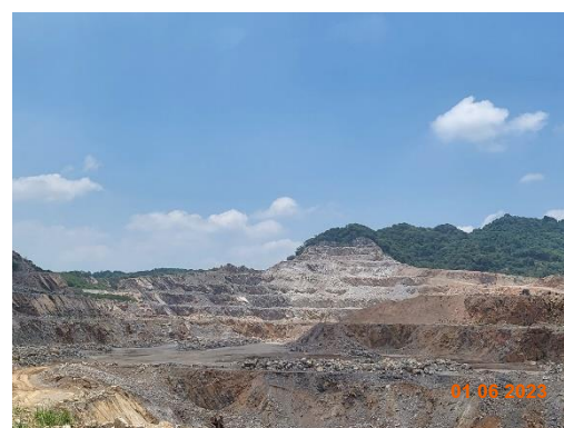
รูปที่ 2-23 ลักษณะการทำเหมืองแบบขั้นบันได
